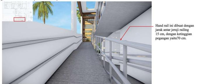
**Gambar 11** Desain Handrail *Ramp* untuk Disabilitas Tuna Daksa
