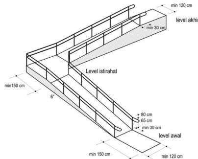
Gambar 9 Bentuk Ramp yang Direkomendasikan
