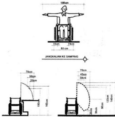
Gambar 6 Batas Jangkauan Samping Pengoperasian Peralatan oleh Pengguna Kursi Roda
