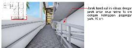
**Gambar 11** Desain Handrail Ramp untuk Disabilitas Tuna Daksa
