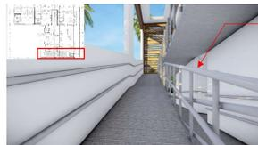
Jarak hand rail ini dibuat dengan jarak antar jeruji railing 15 cm, dengan ketinggian pegangan yaitu 70 cm.
