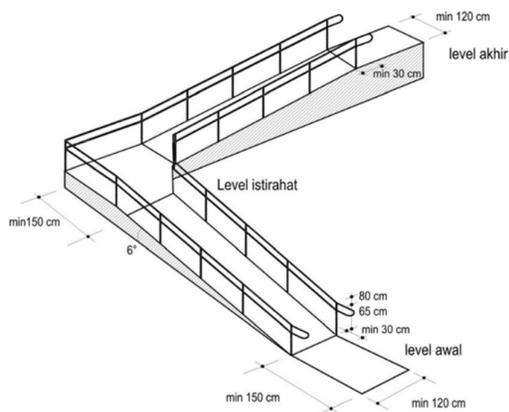
**Gambar 9** Bentuk *Ramp* yang Direkomendasikan
