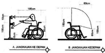
Gambar 7. Batas Jangkauan Depan Pengoperasian Peralatan oleh Pengguna Kursi Roda
