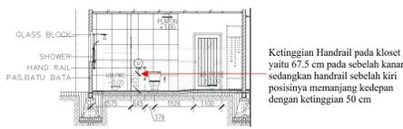
Gambar 10. Desain Ketinggian Handrail
