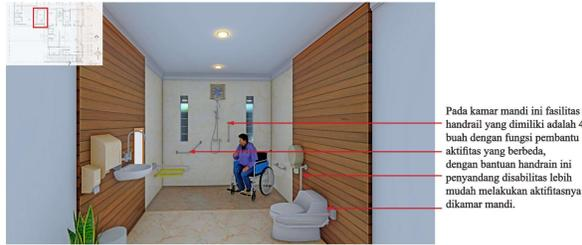
Gambar 17 Penerapan Handrail
