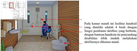
Gambar 9. Desain Handrail
