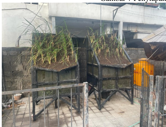
(a) Penanaman rumput gajah dan rumput vetifer sesuai kemiringan lereng dan konfigurasi
